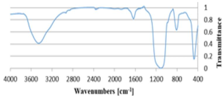
Fig. 3 FTIR spectrum for Aerosil R816 (KBr disk).
