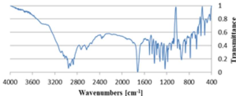
Fig. 1 FTIR spectrum for ibuprofen (KBr disk).
