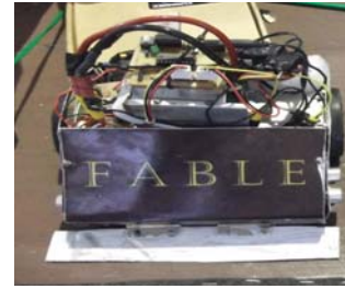
Fig. 2 Sumo robot chassis: 1—Aluminum 6061-T6.
